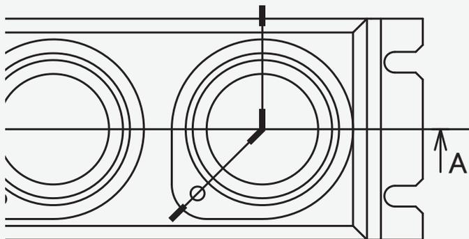
切断線の先端・折れ位置を指示するだけ、矢視は先端位置・文字位置を指定するだけという簡単な操作で作図することができます。
