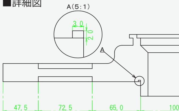
図面の任意のエリアを指定し、簡単に異尺の拡大詳細図が作成できます。元図と詳細図はリンクされ、元図の変更は即座に詳細図に反映されます。
