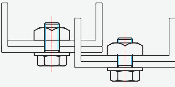
コンテンツで配置した部品、または、ブロック同士が重なった際に、後ろにある部品の見えなくなる部分の形状を陰線処理します。また、陰線処理前に戻すことも出来ます。
