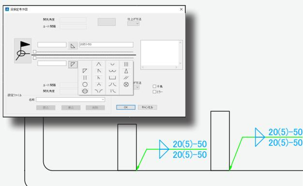
溶接シンボルを専用ダイアログで作図・編集することができます。溶接表示シンボルも選択配置できます。
