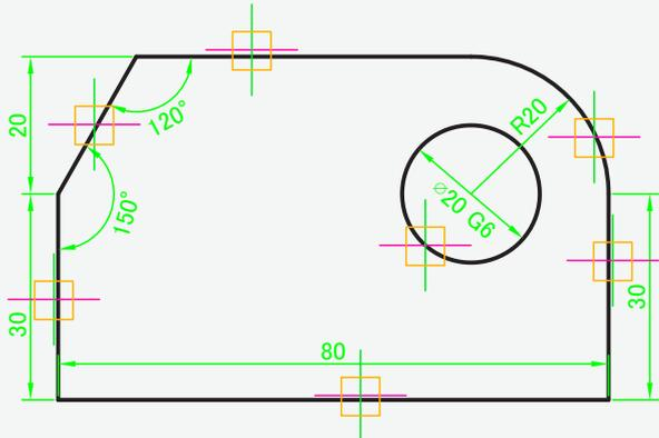
「マルチ寸法」コマンドひとつで、長さ寸法、径長寸法、角度寸法を作成し、さらに寸法編集が可能です。指示したオブジェクトや、指示方法によって寸法種類が自動で切り替わり、操作ステップ数を大幅に減らせます。
