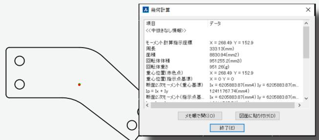
計算対象と計算項目を選択することで、閉領域の周長、面積、重心、モーメントなどを計算します。出力結果は図面へ張り付けることができます。
