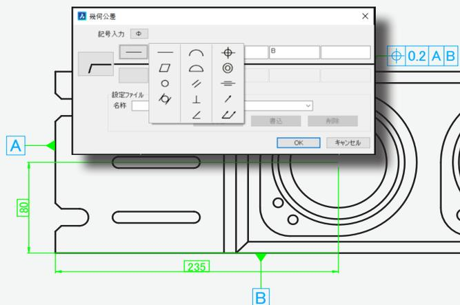
幾何公差を表す幾何公差枠やデータムシンボルを専用ダイアログで簡単に作図・挿入することができます。
