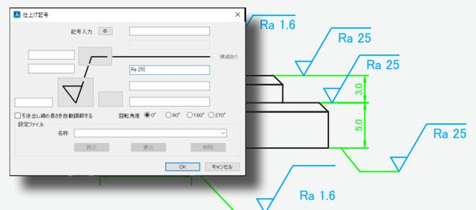
表面粗さ範囲の仕上げ記号シンボルを専用ダイアログで作図・挿入・編集することができます。
