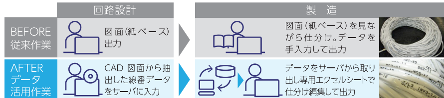
部品マスタデータを活用したアイム製作所での業務フロー
